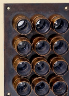
Französische Multiplikator-Optik mit 12 identischen Petzval-Optiken 4.5/50 mm, um 1865 Schätzpreis: € 1.400–2.200
